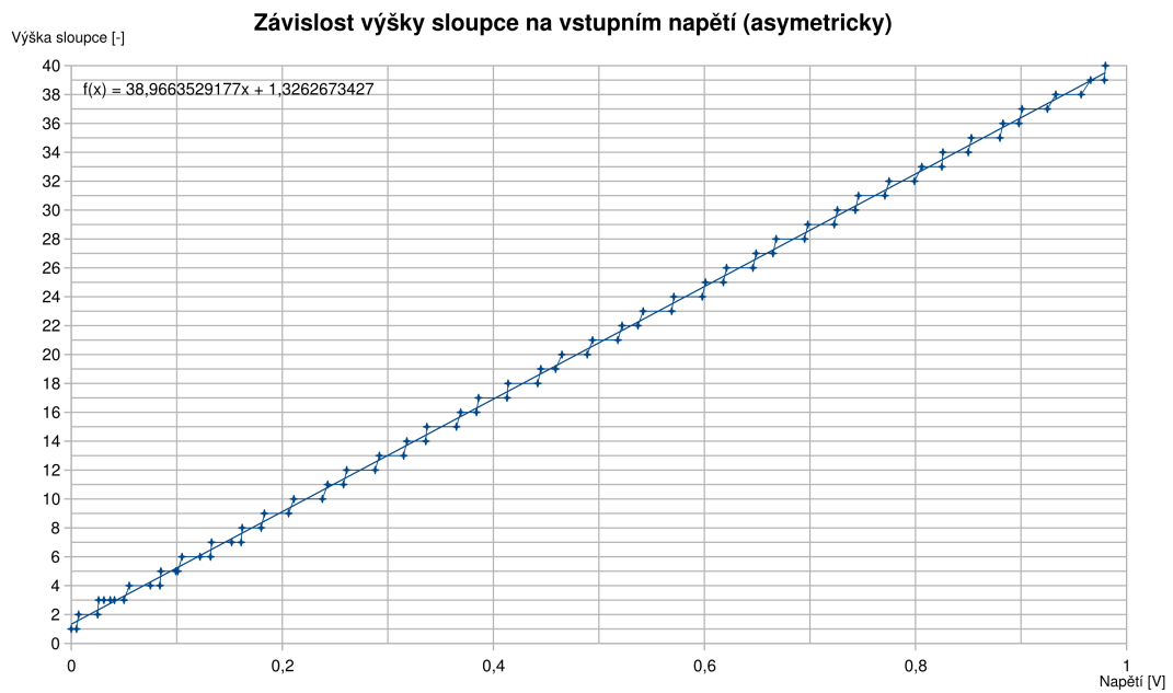
Obr. 3.2: Převodní charakteristika pro unipolární signál
