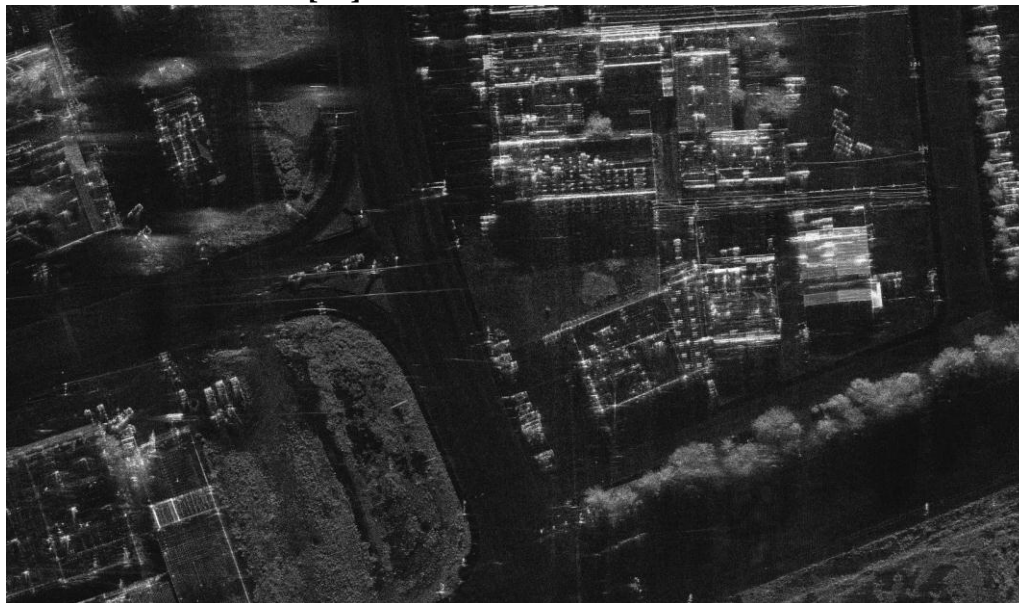
50. Obr. Snímka z radaru SAR z výšky 400m s rozlíšením 2,5"x2,5" (3GHz) [27]
