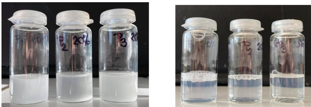
Obrázek 19: Vzorky Prodanu obsahující 20 mol. % cholesterol. Vlevo před sonifikací pomocí vodní lázně, vpravo po sonifikaci.
