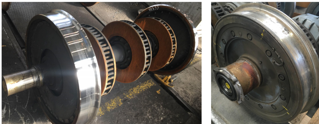
Obr. 10 Vlevo dvojkolí s odhlučnými celistvými koly a třemi brzdovými kotouči, vpravo příklad odpruženého složeného kola z motorového vozu 840 Stadler.
