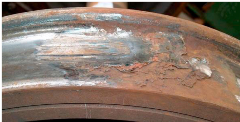
Obr. 15 Železniční dvojkolí s probrzděnou plochou [29].
