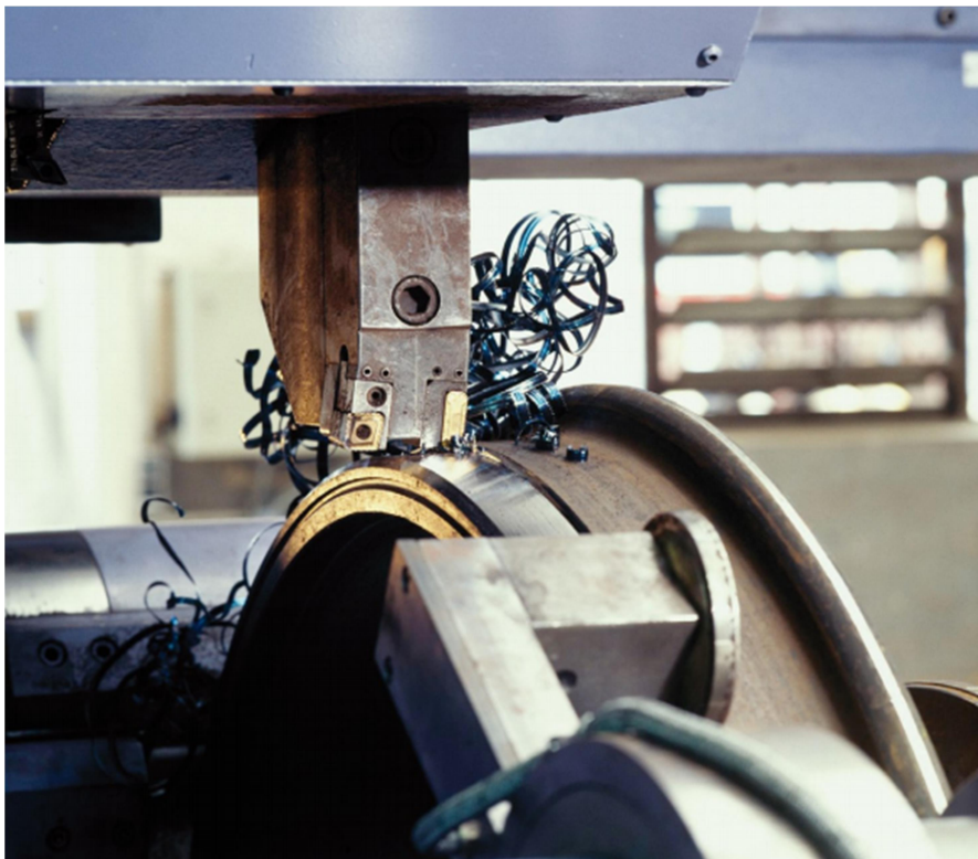
Obr. 19 Soustružení jízdního obrysu [20].
