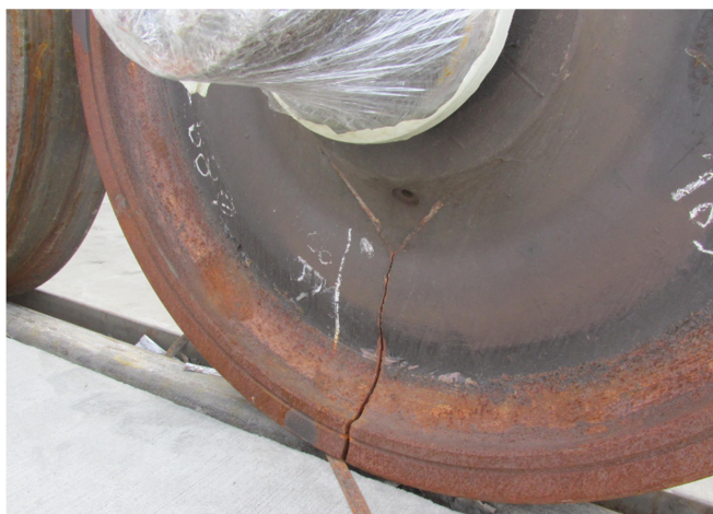
Obr. 16 Monoblokové dvojkolí číslo 1233 s poškozeným tepelným nátěrem. Toto poškození naznačuje přítomnost nežádoucích vnitřních zbytkových pnutí v kole. Trhлина vznikla v důsledku neodstraněného pnutí. Pomocí nátěru je možno sledovat tepelné i napěťové změny v materiálu.
