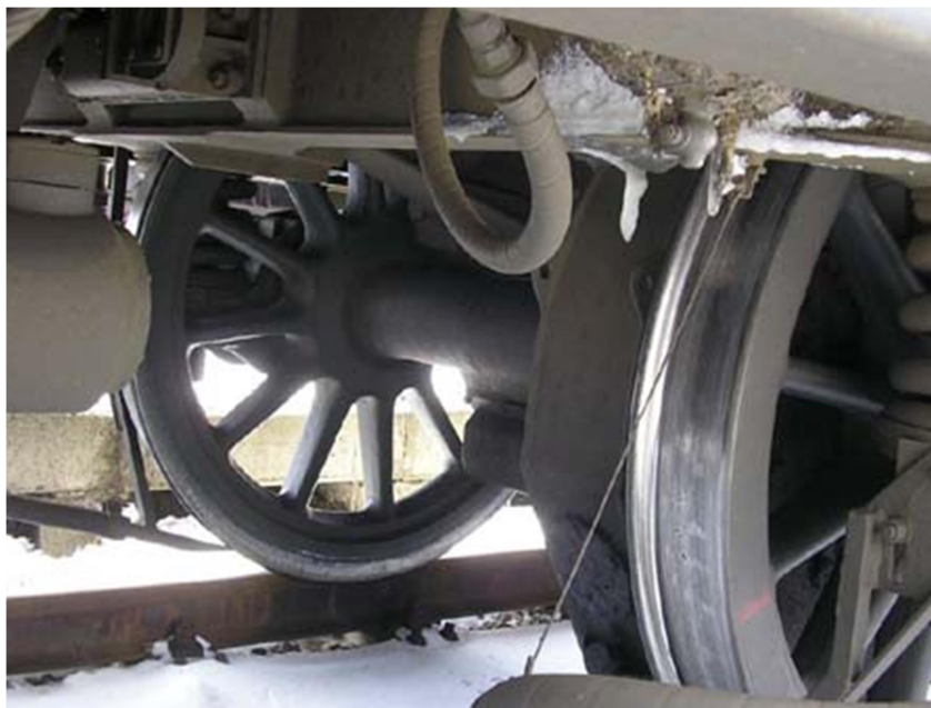
Obr. 21 Pohled na hvězdicové dvojkolí lokomotivy 363, na pravé straně nápravy je patrný kryt nápravové převodovky [37].
