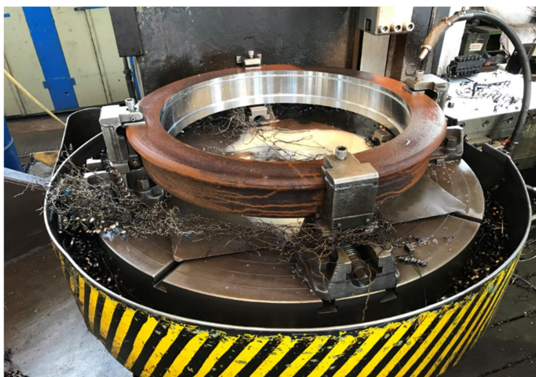
Obr. 24 Obruč upnutá na Karuselu 1516 před montáží na dvojkolí. Obroběny dosedací plochy.
