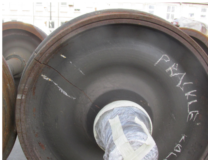
Obr. 17 Monoblokové dvojkolí číslo 1231 s trhlinou. Zde je příklad, kdy i přes překročenou mez vnitřního pnutí není znatelná degradace nátěru, zbytkové pnutí přítomno.
