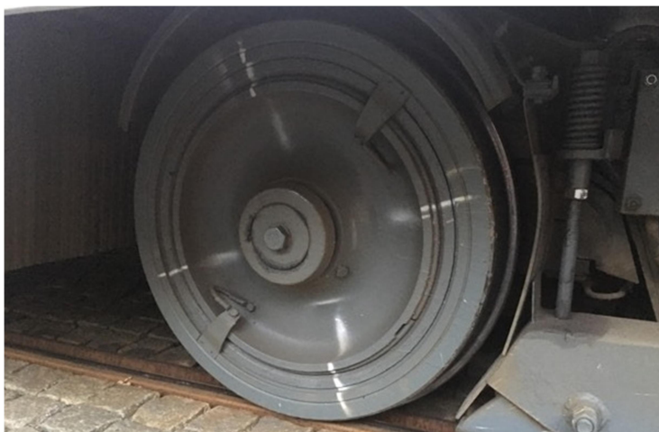
Obr. 25 Barevné značení vzájemné polohy kotouče a obruče.
