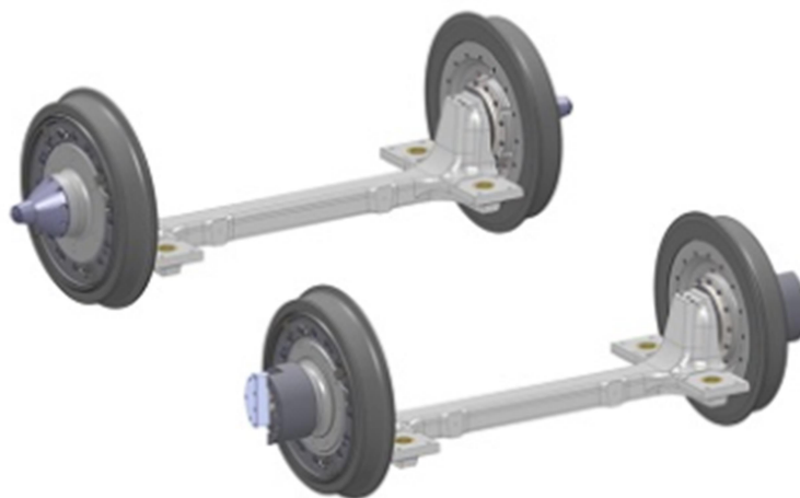
Obr. 13 Nápravnice s nosností 12.500 kg pro tramvajová kola firmy Bonatrans a.s. [25].
