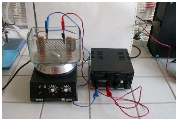
Obr. 3: Fotografie aparatury se zdrojem napětí, elektromagnetickým míchadlem a platinovými elektrodami
