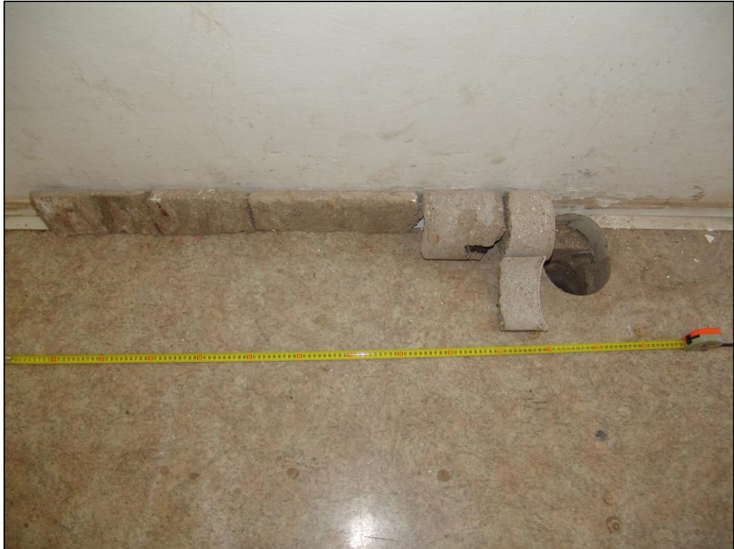
Obr. 36: Vrt P2 – složení konstrukce podlahy [23]
