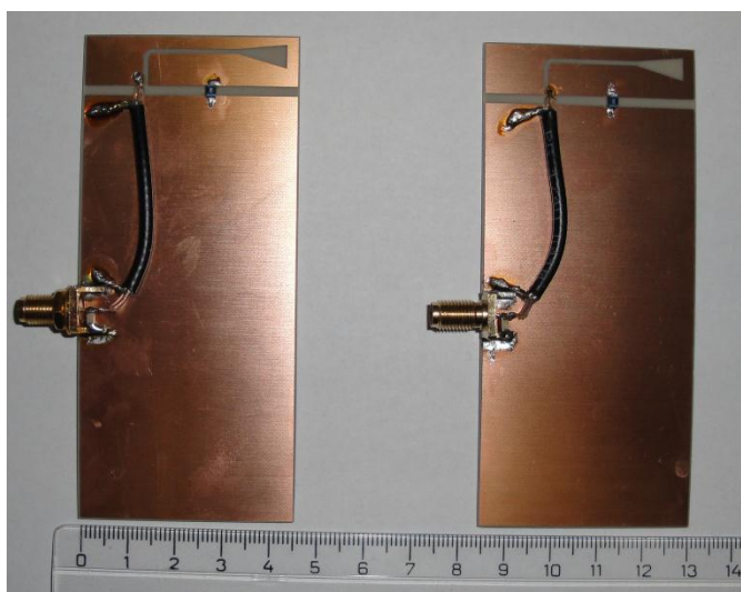
Obr. 5.2 Pohled na vyrobený model antény PN bez aktivního přepínacího prvku, mód 1 vlevo a mód 0 vpravo.
