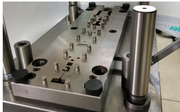
Obr. 11 Řezání vodním paprskem [35]. Obr. 12 Postupový střížný nástroj [45].
