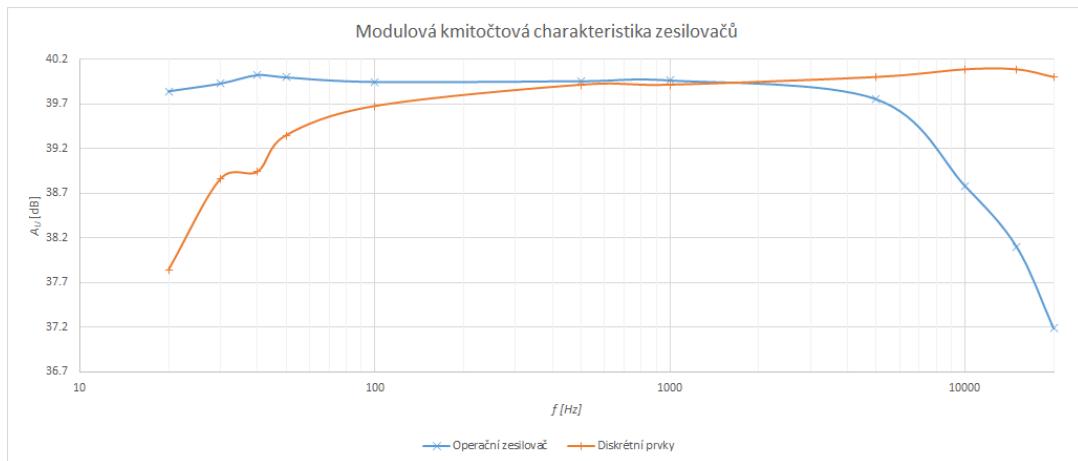
Obr. E.1: Změřená modulová frekvenční charakteristika zesilovačů
