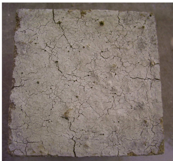
Obr. č. 134: Detail výrazně porušeného povrchu vzorku směsi II po teplotním zatížení až do teploty 1110 °C – povrch vzorku je protkán sítí trhlin
