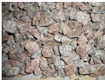
Obr. č. 47: Olbramovice po 700 °C
