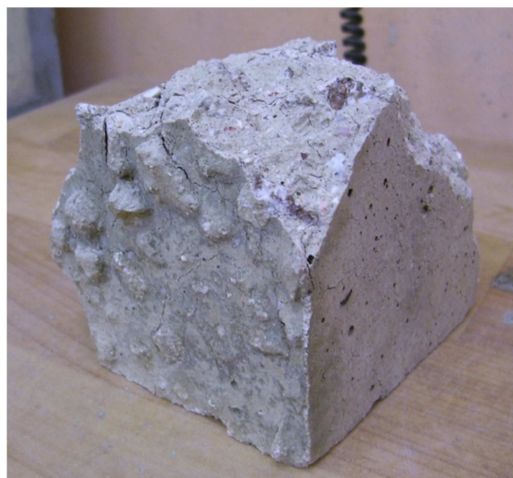
Obr. č. 135: Detail vzorku směsi III m po teplotním zatížení až do teploty 1110 °C – destrukce vzorku
