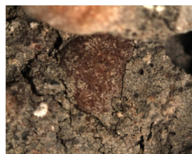
Obr. č. 78: Detail po 1 000 °C – recyklát (zvětšeno 40×)
