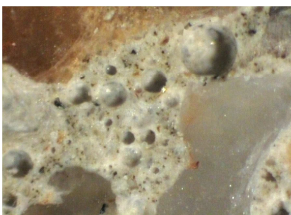
Obr. č. 96: Mikrostruktura bez poruch a bez přítomnosti vláken po 250 °C
