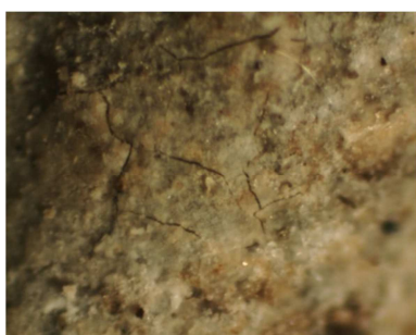
Obr. č. 76: Detail po 400 °C – recyklát (zvětšeno 260×)
