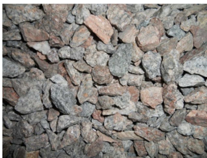
Obr. č. 46: Olbramovice po 400 °C
