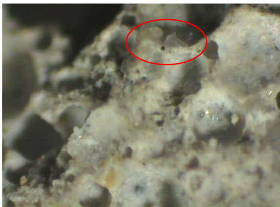
Obr. č. 92: Viditelně zdeformovaná vlákna po 150 °C
