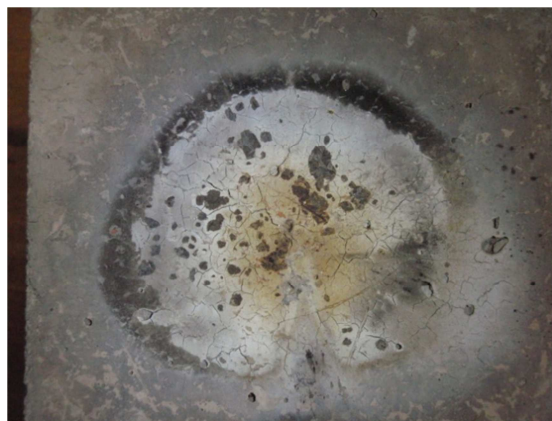
Obr. č. 153: Detail exponovaného povrchu po zkoušce, vzorek III 1 – vodní uložení (vlhkost 4,9 %, maximální teplota 1 199 °C)
