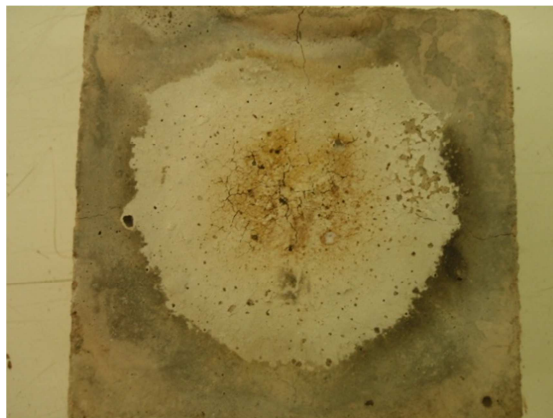
Obr. č. 147: Detail exponovaného povrchu po zkoušce, vzorek II – vodní uložení (vlhkost 6,4 %, maximální teplota 1 232 °C)
