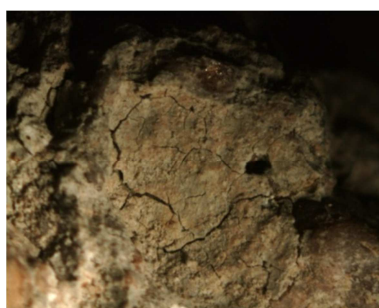
Obr. č. 77: Detail po 700 °C – recyklát (zvětšeno 40×)
