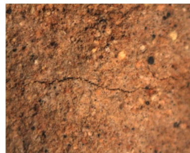
Obr. č. 81: Detail po 1 000 °C – sbalky (zvětšeno 40×)
