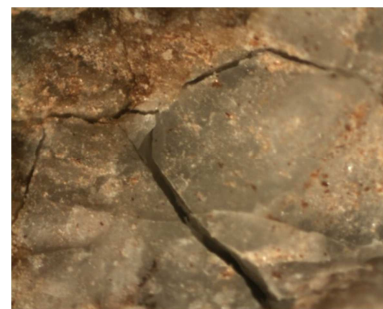
Obr. č. 69: Detail po 1 000 °C – Olbramovice (zvětšeno 60×)
