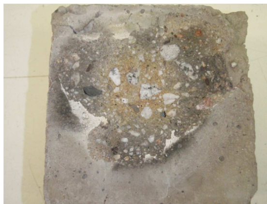
Obr. č. 155: Detail exponovaného povrchu po zkoušce, vzorek IV – vodní uložení (vlhkost 4,4 %, maximální teplota 1 279 °C)
