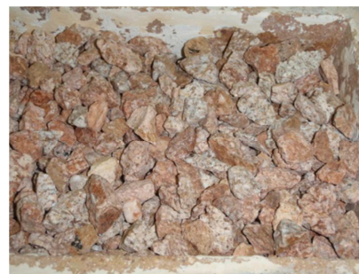
Obr. č. 48: Olbramovice po 1 000 °C
