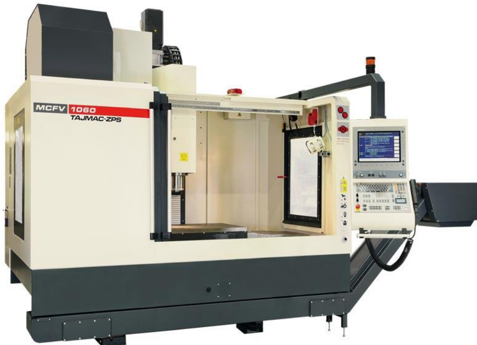
Obr. 22 – Vertikální obráběcí centrum Tajmac – ZPS MCFV 1060 [6]
