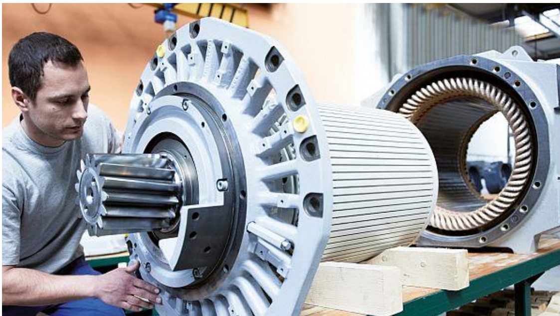
Obr. 1 – Montáž trakčního motoru do kolejových vozidel [1]
