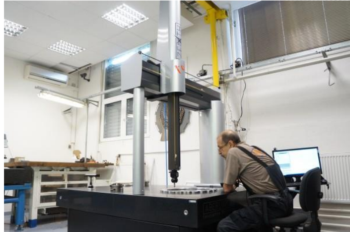
Obr. 51 – 3D souřadnicový měřicí přístroj Aberling Zenith Too 155 [6]
