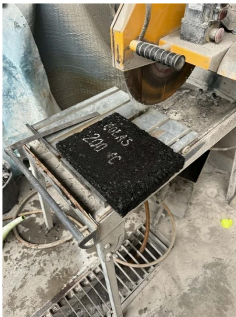
Obrázek 12 Řezání zkušebních těles
