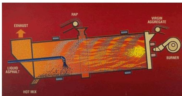
Obrázek 6 Schéma metody Drum-mix [16]
