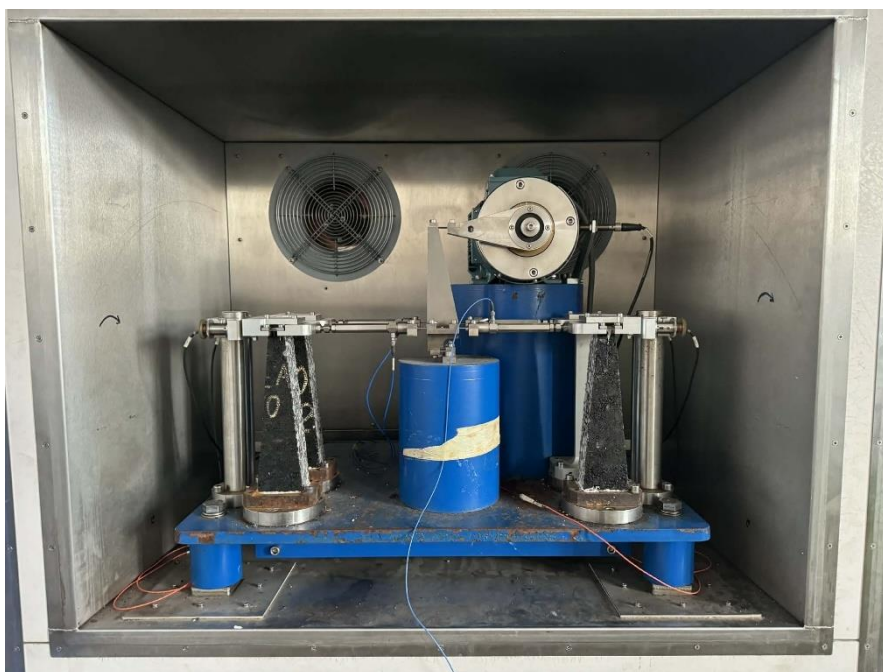
Obrázek 20 Zkušební tělesa zkoušky tuhosti ve zkušebním zařízení
