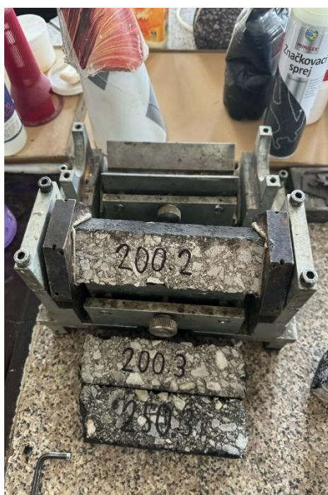
Obrázek 15 Lepení vzorku v centrovacím rámu
