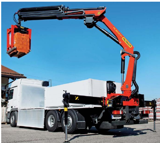
Obrázek 77: Nákladní automobil typu valník MAN TGX 26.360 s hydraulickou rukou Palfinger PK 16002
