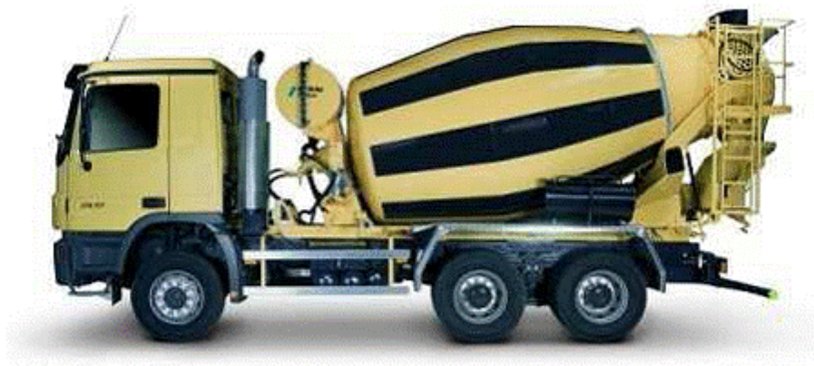
Obrázek 65: Autodomíchávač Schwing STETTER AM 8C na podvozku MAN TGM 26.340
