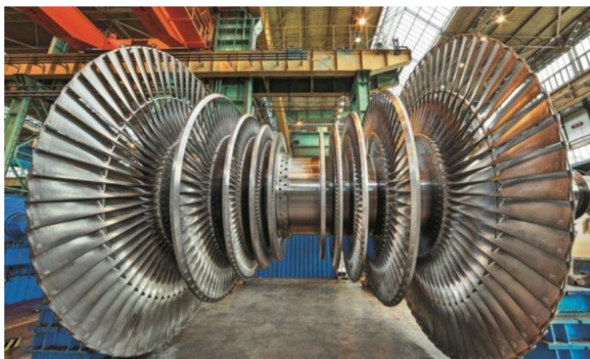
Obr. 2-2 Rotor dvouproudé turbíny Škoda [27]
