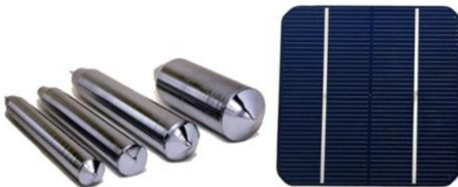
Obr. 1.8 Monokrystalické křemíkové ingoty a článek z nich vyrobený [19]
