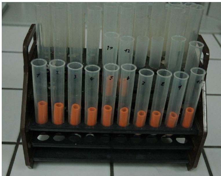
Obr. 20 Plastové zkumavky s distanční vložkou k odstředování vzorků
