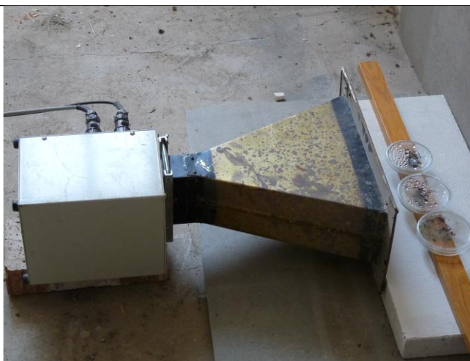
Obr. 4– Trychtýřová anténa mikrovlnného generátoru při likvidaci biotických škůdců v podobě plísni
