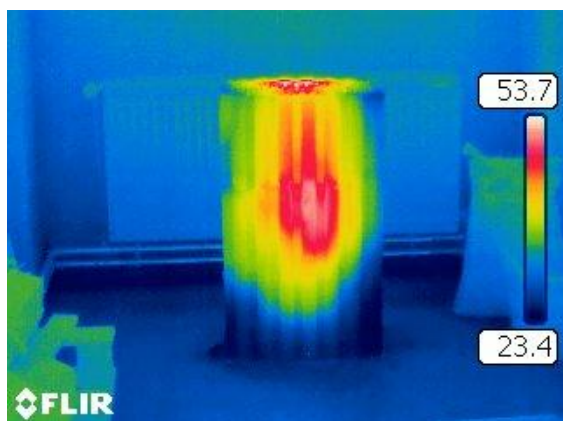
Obr. 2 – Reálné snímky při vysušování keramických tvárnic a zobrazené teploty po ozařování vyhodnocené termokamerou
