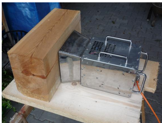
Obr. 1 – Reálné snímky dřevěného prvku zobrazené termokamerou a reálného mikrovlnného generátoru s trychtýřovou anténou Fig. 1 – The real timber member images displayed thermocamera and real microwave generator with horn antenna
