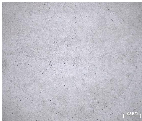
Obr. 5.17 Mikrostruktura vzorku SLM H70 na SM, zvětšeno 1000x.
