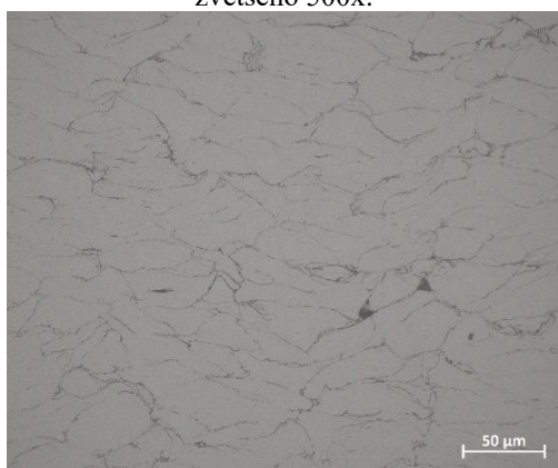
Obr. 5.12 Mikrostruktura vzorku CS 50 na SM, zvětšeno 500x.
