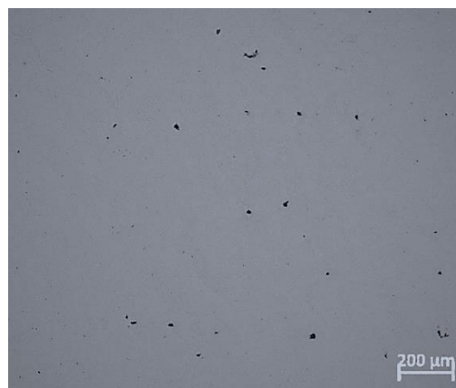
Obr. 5.5 Pórovitost vzorku CS 50 HT na SM, zvětšeno 10x.
