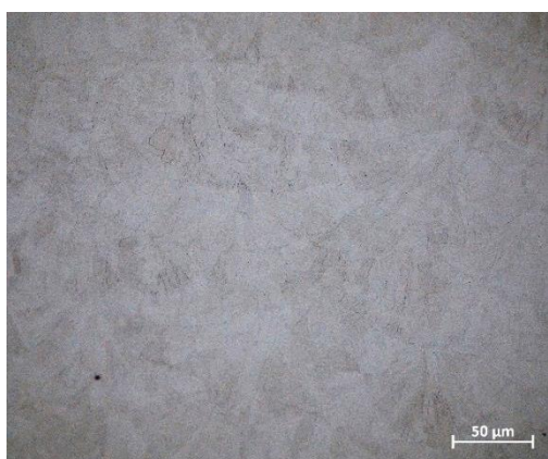
Obr. 5.20 Mikrostruktura vzorku SLM R50 na SM, zvětšeno 500x.
