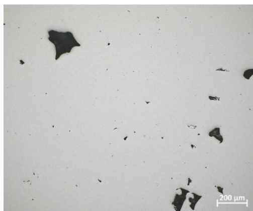
Obr. 5.6 Pórovitost vzorku SLM H50 na SM, zvětšeno 10x.
