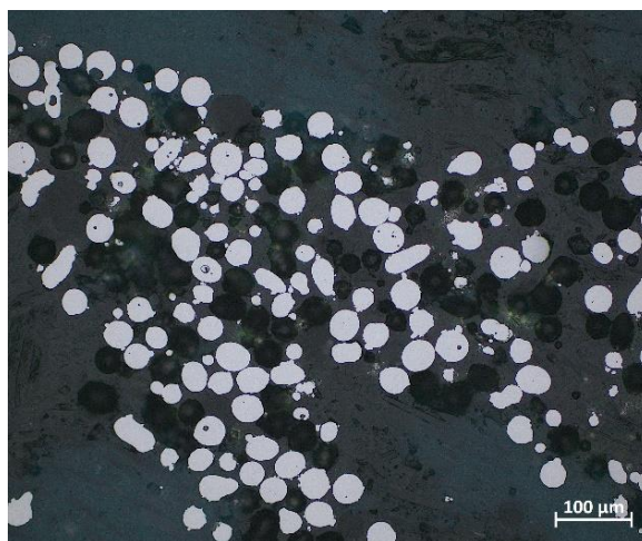
Obr. 4.1 Metalurgický výbrus použitého prášku, SM.
