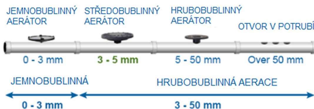
Obrázek 2-2 – Schematické rozdělení pneumatické aerace [8]
