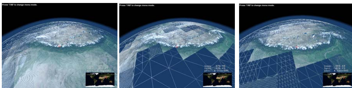
Obrázek 7.5: Způsoby výběru úrovní detailu (vlevo pomocí vzdálenosti, uprostřed pomocí pixel error, vpravo kombinace)
