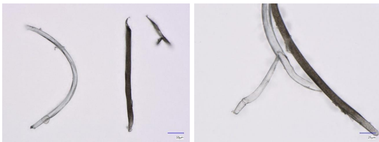
Obrázek 41: Vlákno polypropylenové a polyamidové, měřítko 50 a 25 \mu\text{m} .
