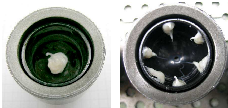
Obr.č. 17: nanášení mazacího tuku při montáži
