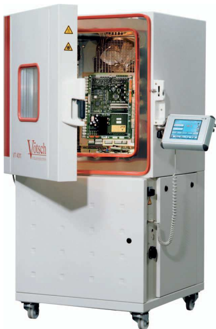
Obr. č. 19: Klimatická komora Vötsch [9]
