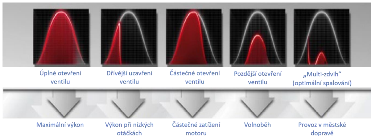
Obr. 27 Časování sacího ventilu u motoru Fiat MultiAir [18]
