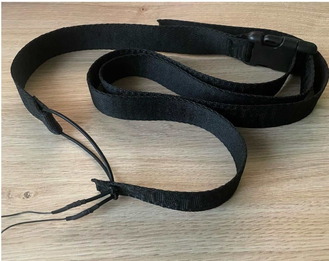
Obr. 9 Testovací verze senzoru pro měření dechové frekvence
