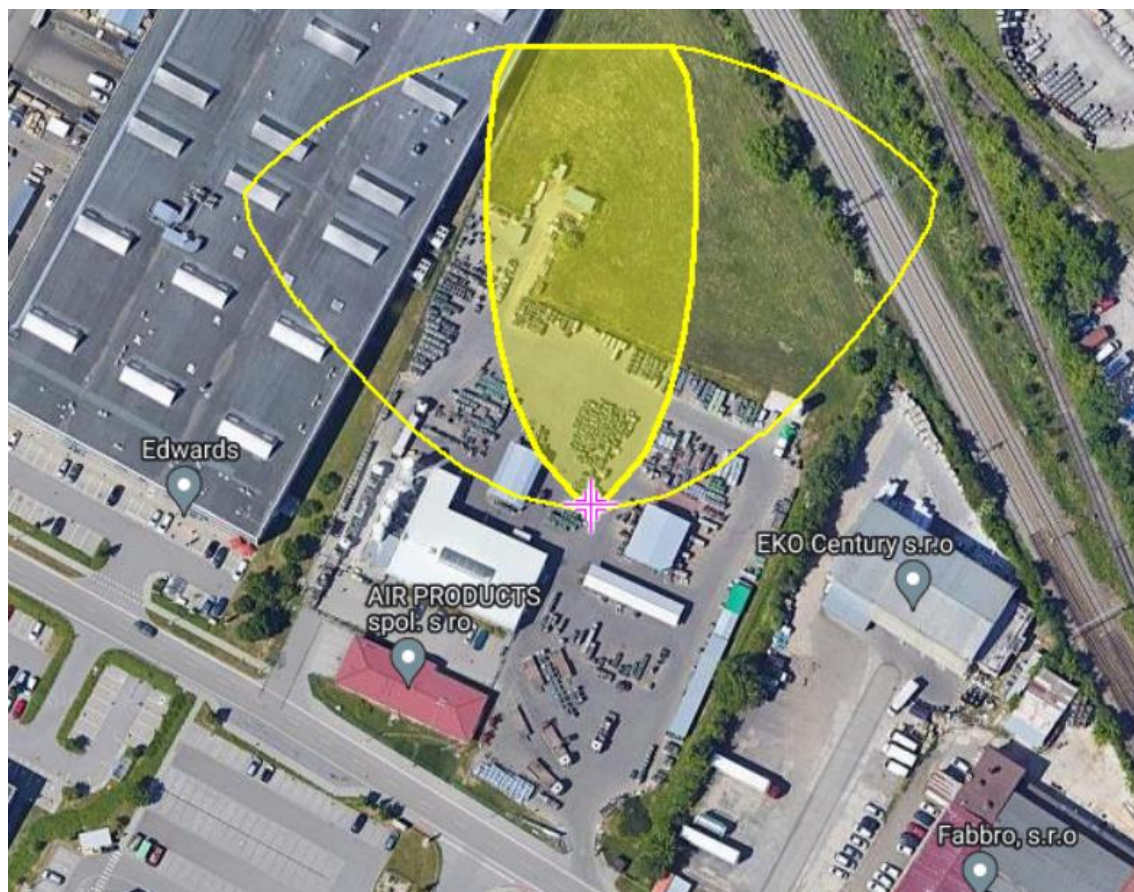
Obr. 3.15 Mapové zobrazení flash fire acetylenový svazek lahví [výstup ze softwaru ALOHA]
