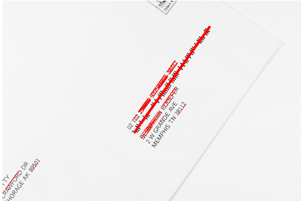
Obrázek 7.7: Výsledek pravděpodobnostní Houghovy transformace s nalezením přímek při hledání hrubého úhlu natočení IMB kódu.
