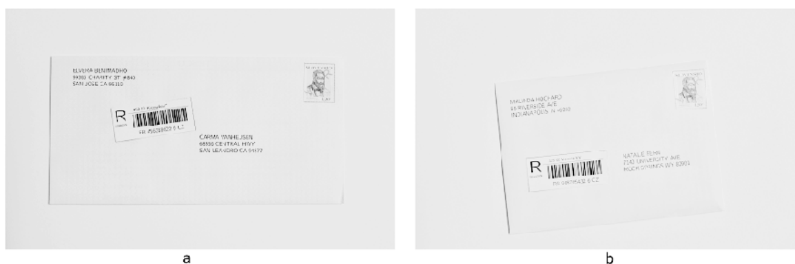
Obrázek 6.2: Testovací snímek pro kód C128 a) standardní DL obálka, b) malá obálka.
