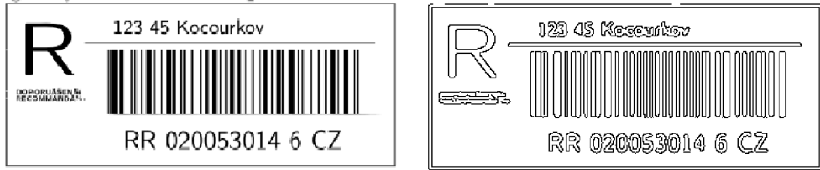
Obrázek 4.1: Originál (vlevo) a výsledek Cannyho hranového detektoru (vpravo). Byla použita funkce z programu Matlab.
