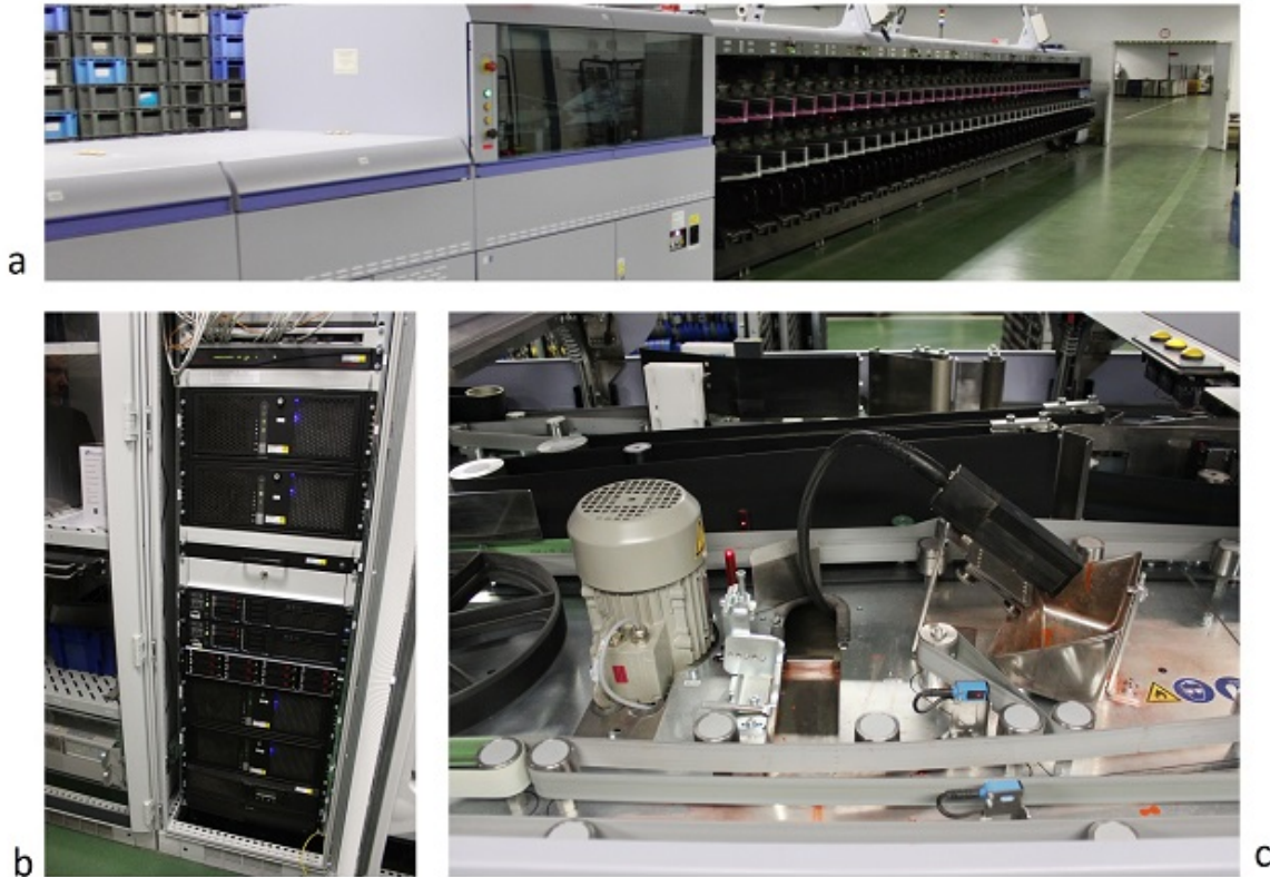
Obrázek 4.9: Třídící stroj. a) Pohled na část s přihrádkami na roztříděné obálky. b) Server. c) Tiskárna IMB kódu v odstávce.
