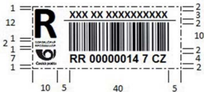
Obrázek 2.3: Parametry pro podací nálepku na Doporučené zásilky. Rozměry jsou udány v milimetrech. [28]
