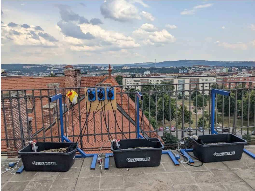
Obrázek 8 Trojice paralelních systémů k měření evapotranspirace (29. června 2022)
