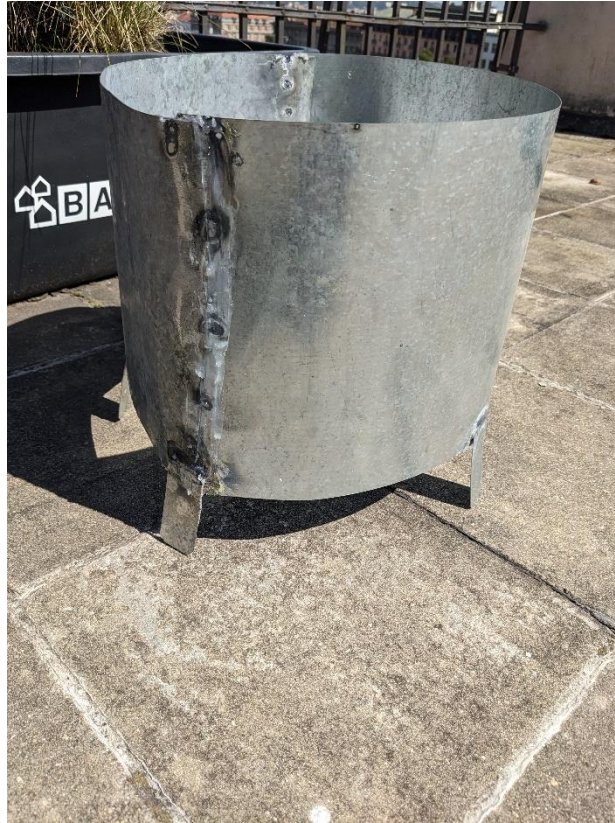
Obrázek 10 Přepážka z pozinkovaného plechu pro oddělení oleje od pytle (14. srpna 2023)
