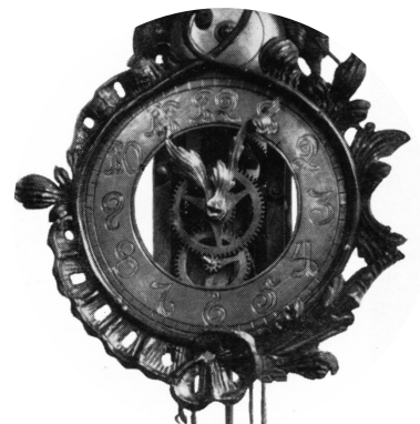
Obr. 9 Tzv. Jacquemarty s obnaženým mechanismem
