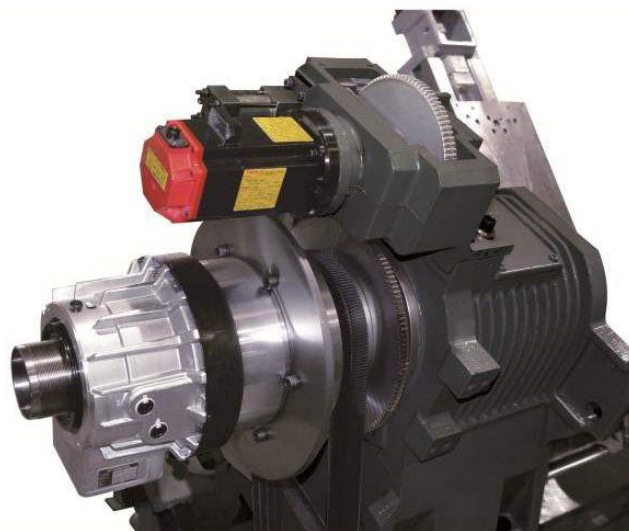
Obr. 21) Náhon osy C pomocí ozubeného soukolí [31]
