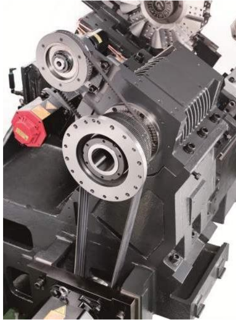
Obr. 20) Náhon osy C pomocí řemenu[31]
