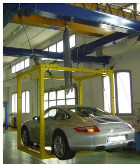
Obr. 23 Ukázka měření třívláknovým závěsem [13]
