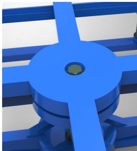
Obr. 32 Otočný čep s axiálním ložiskem
