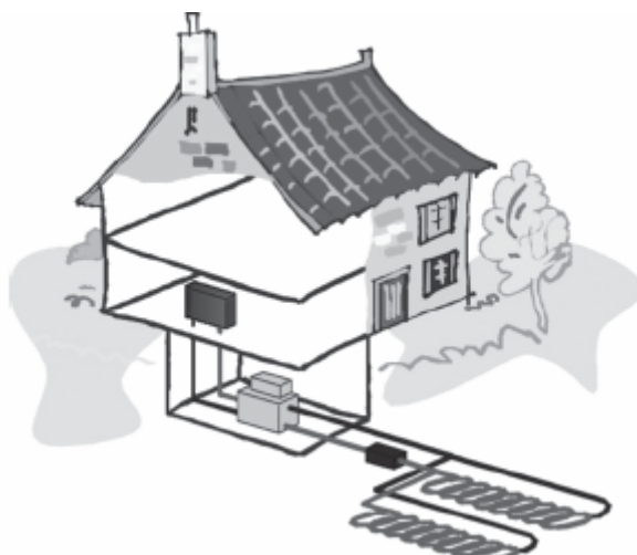
Obr. 16 Schéma systému Horizontální kolektory [13]
