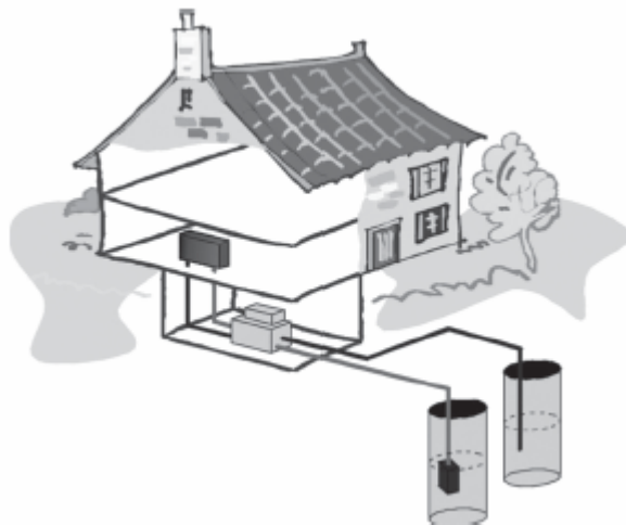
Obr. 18 Schéma systému voda – voda [13]
