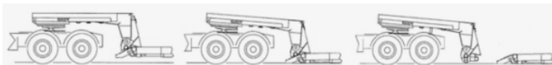
Obr. 3-13 Princip nájezdové rampy podvalníku [26]
