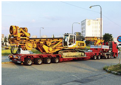
Obr. 3-12 Podvalník Goldhofer STZ-VH 6 [25]
