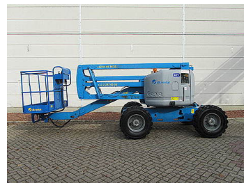
Obr. 3-21 Kloubová plošina Z-45/25 JRT [36]
