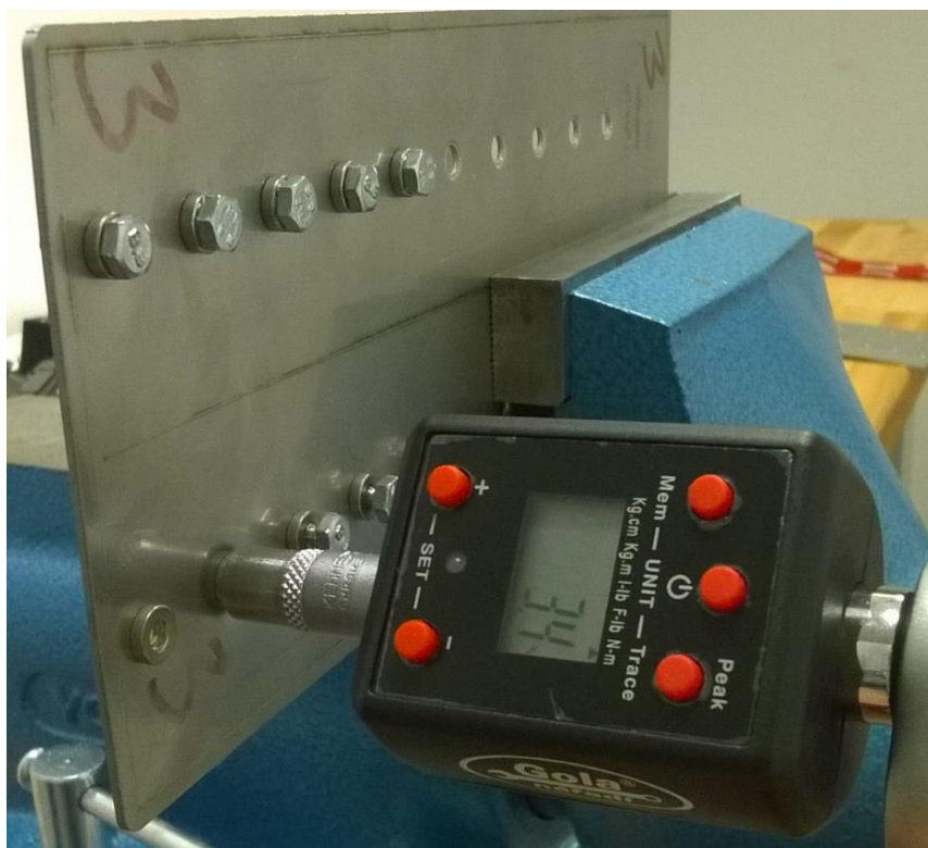
Obr. 19 Měření pomocí digitálního momentového adaptéru.
