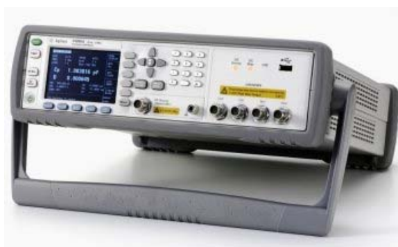
Obr. 16: Měřicí přístroj Agilent RLC- metr E4980A
