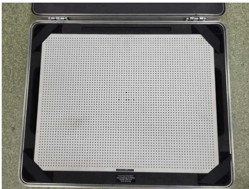
Obr. 8 Kalibrační deska CP40/MV320 umístěna v přenosném kufru
