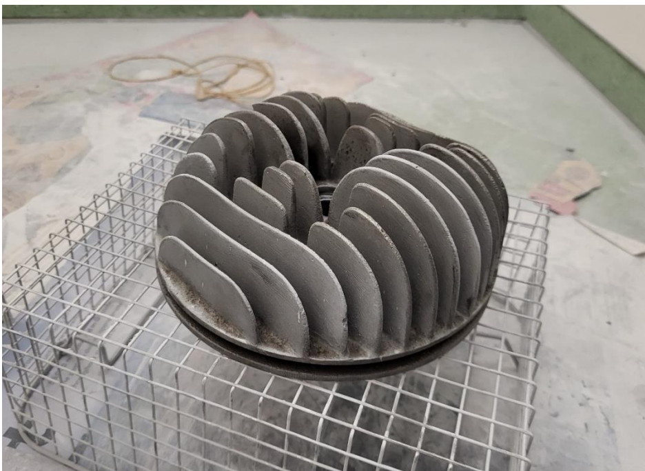
Obr. 9 Aplikace křídového povlaku na hlavu válce
