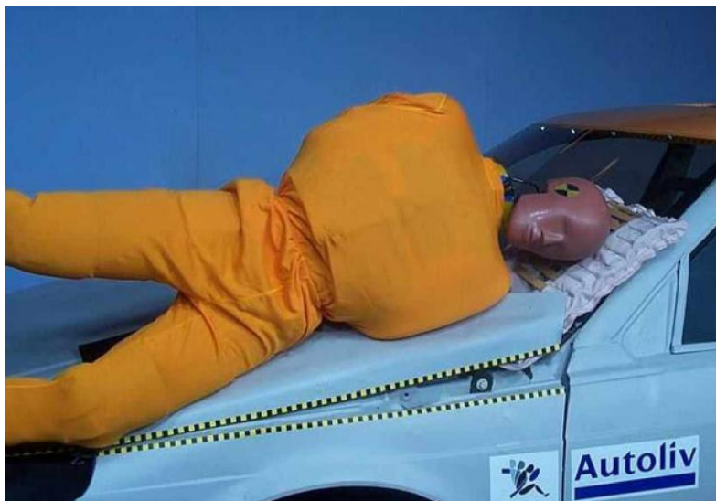
Obr. 5 Airbag pro chodce implementovaný v aktivní kapotě [4]
