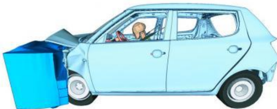
Obr. 32 Výpočtový model automobilu při simulaci čelního nárazu dle předpisů Euro NCAP [15]
