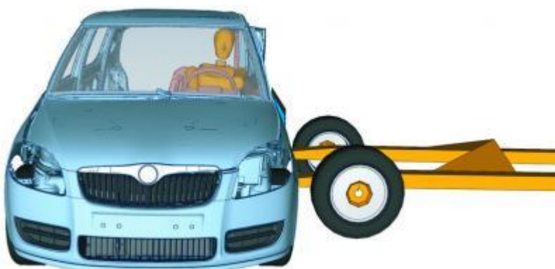
Obr. 34 Výpočtový model automobilu při simulaci bočního nárazu dle předpisů Euro NCAP [15]
