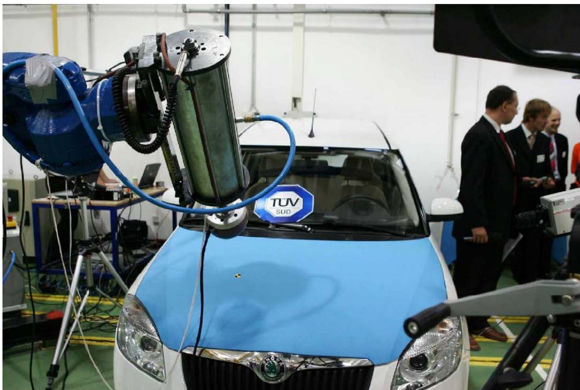
Obr. 23 Vystřelovací zařízení impaktoru [11]
