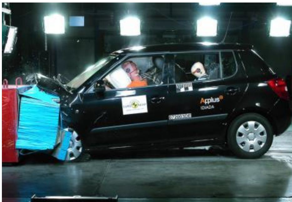
Obr. 31 Zdeformovaný tvar vozu při čelním nárazu dle předpisů Euro NCAP [8]
