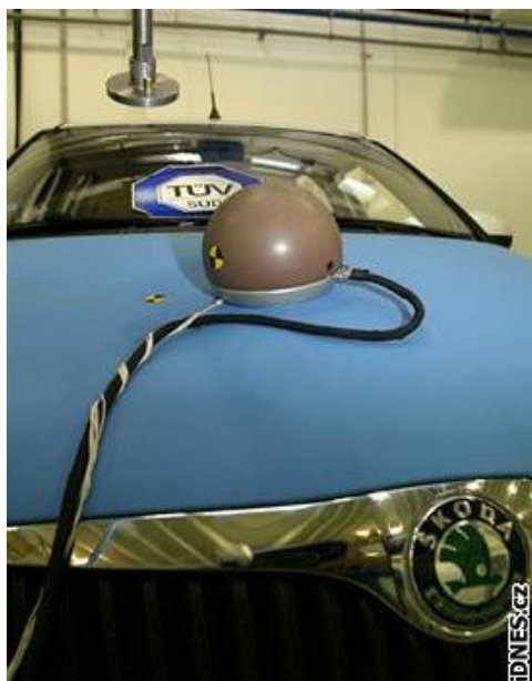
Obr. 24 Spojení a fáze volného letu impaktoru [1] a [8]
