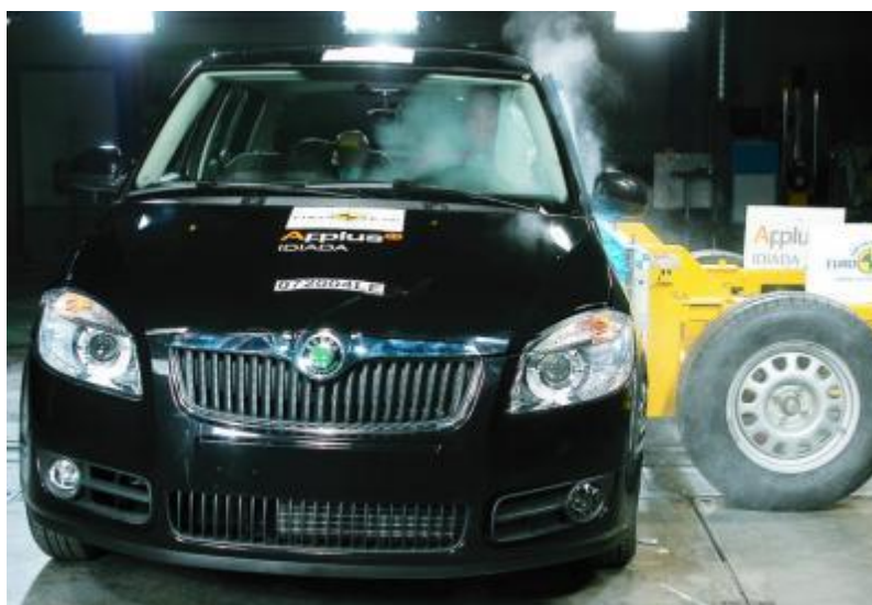
Obr. 33 Zdeformovaný tvar vozu při bočním nárazu dle předpisů Euro NCAP [8]
