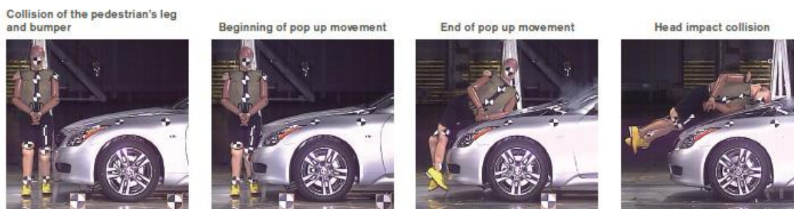
Obr. 4 Srážka chodce s aktivní kapotou [3]
