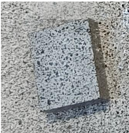
Obr. 29 Vzorky s nanášenou texturou pro DIC.
