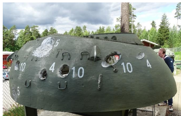
Obr. 2 Průstřely věže tanku [6].
