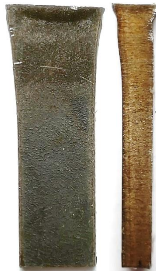
Obr. 51 Deformovaný vzorek 453 po TAT.
