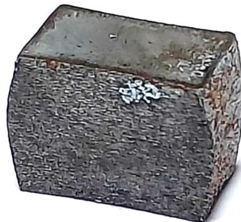
Obr. 33 Vzorek po kvazistatické zkoušce.
