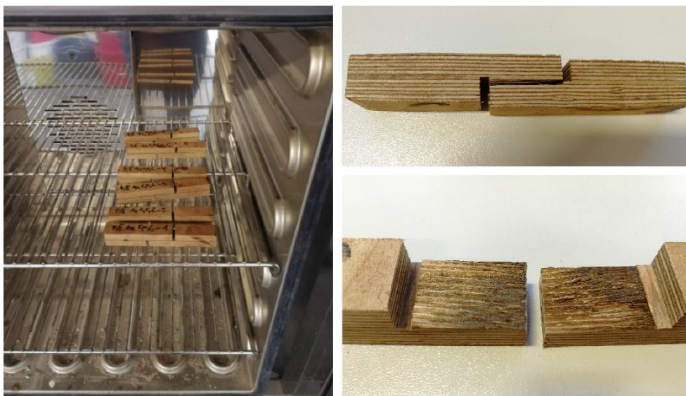
Obrázek 35) Ukázka zkušebních těles umístěné v expozičním prostředí o teplotě 180 °C a příklad porušení vzorku (1× REF bříza) po smykové zkoušce se 40% kohezním porušením ve dřevní části.
