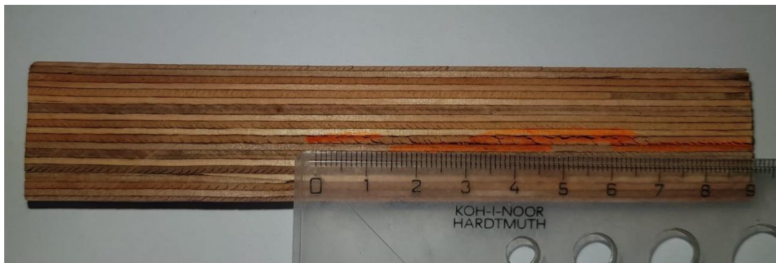
Obrázek 37) Ukázka způsobu porušení a měření delaminace zkoušeného vzorku 2 \times \text{REF} .
