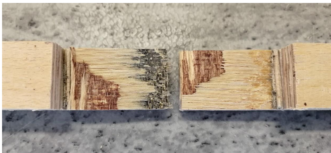
Obrázek 34) Ukázka porušení tělesa (1× 556 buk) po namáhání v místě smykové plochy výztuže s 55% kohezním porušením v dřevní části vzorku.
