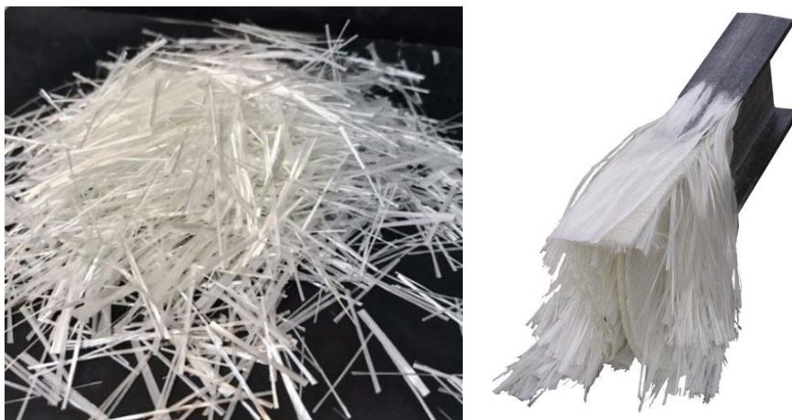
Obrázek 1) Ukázka skleněných GFRP vláken (vlevo) a konečného produktu kompozitního „I“ nosníku vyrobeného z tohoto typu vláken (vpravo). [7; 8]
