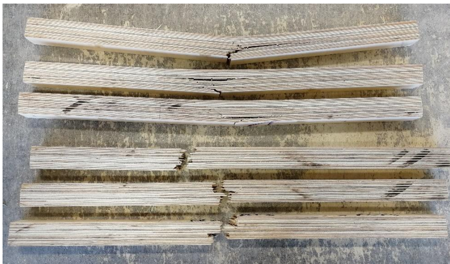
Obrázek 30) Ukázka porušení zkušebních těles po působení ohybového namáhání na vodorovnou (horní vzorky) a svislou orientaci lepené spáry (dolní vzorky).
