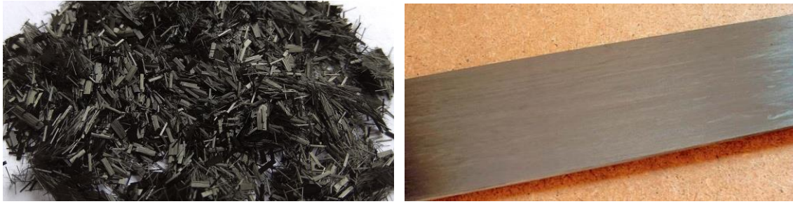
Obrázek 2) Ukázka uhlíkových CFRP vláken (vlevo) a konečného produktu výztužné lamely vyrobené z tohoto typu vláken (vpravo). [9; 3]
