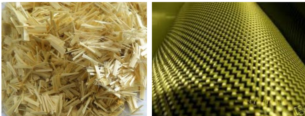
Obrázek 3) Ukázka aramidových AFRP vláken (vlevo) a konečného produktu výztužné tkaniny vyrobené z tohoto typu vláken (vpravo). [10; 11]
