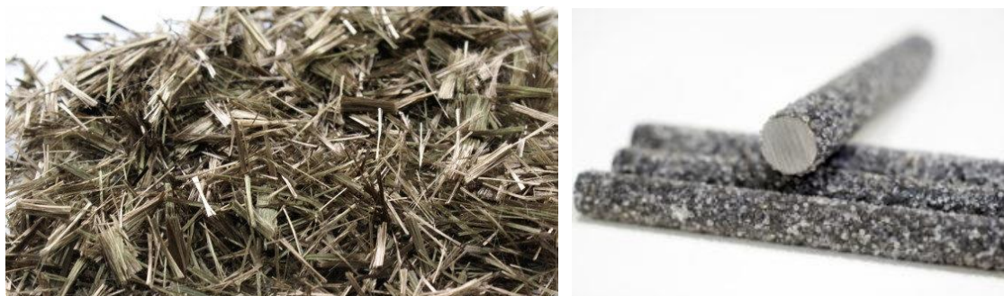
Obrázek 4) Ukázka čedičových BFRP vláken (vlevo) a konečných produktů výztužných tyčí vyrobených z tohoto typu vláken (vpravo). [14; 15]
