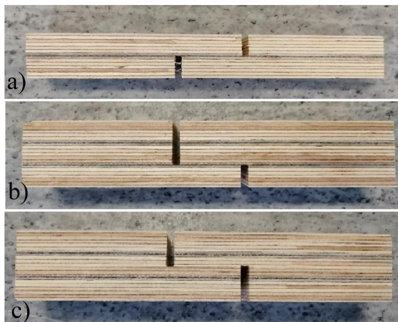
Obrázek 33) Úprava zkušebních těles: a) vzorek 1× BFRP se smykovou plochou ve výztuži, b) vzorek 2× BFRP se smykovou plochou ve výztuži, c) vzorek 2× BFRP se smykovou plochou v překližované části tělesa.
