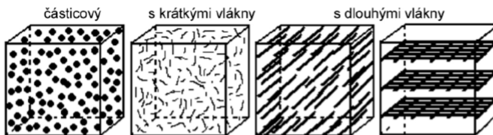
Obr. 20) Částicové a vláknové výztuže v kompozitním materiálu [40]
