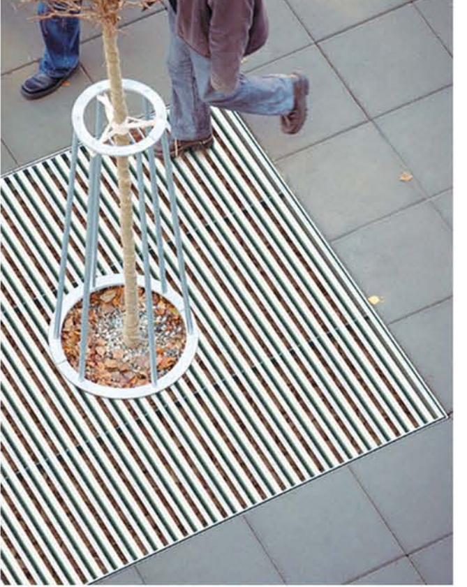
ČTVERCOVÁ MŘÍŽE KE STROMŮM zinkovaná konstrukce z ohýbaných ocelových profilů v pohledovém stavu, rozměr 1600x1600 mm, v zesílené variantě vhodné i pro pojezd aut
