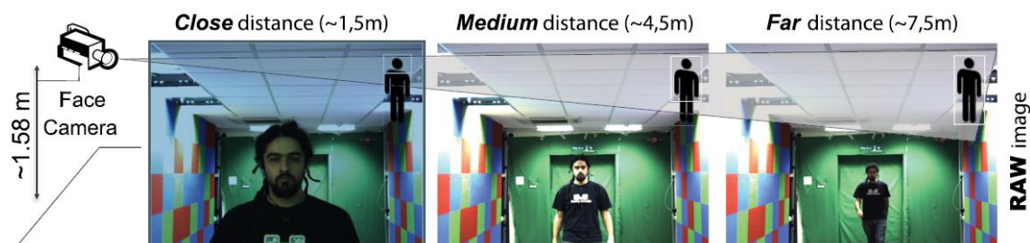
Obrázek 3.4 – Identifikace sekundárních biometrických znaků pomocí kamery [10]
