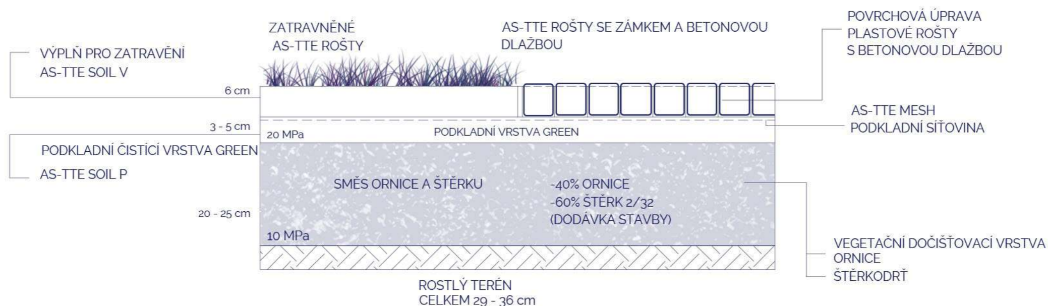
AS-TTE ROŠT pro propustné zpevněné povrchy skladba s čistící schopností pro zatížení osobními automobily a občanské zatížení nákladními auty
