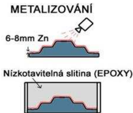
Obr.4 – Výroba formy metalizací [3]
