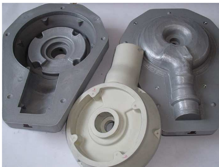
Obr. 6 – Forma vyrobená obráběním i s modelem [4]
