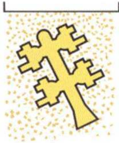
Obr. 14 – Sprchový posyp keramickým ostřivem [3]
