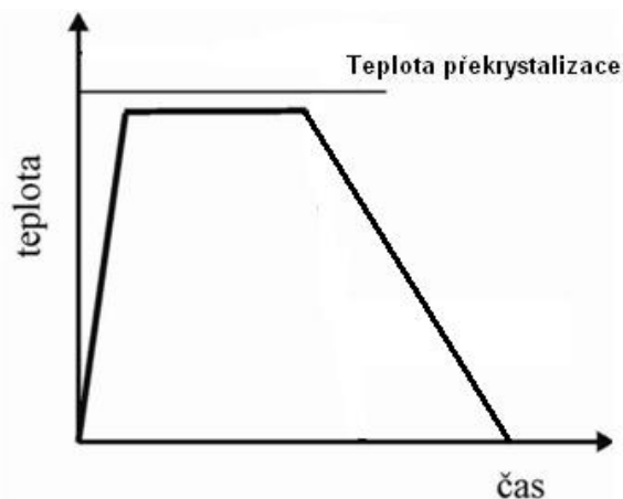
Obr. 30 – Žíhání k odstranění pnutí [27]
