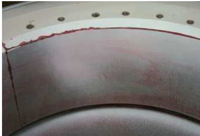
Obr 37 – Kapilární metoda zkoušení [37]
