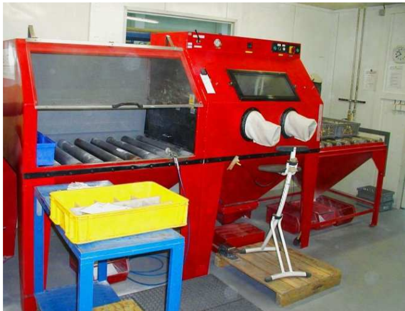
Obr. 27 – Tlakové tryskací zařízení [25]
