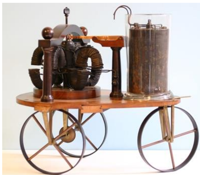
Obr.2.2 Elektrické vozidlo zostrojené profesorom Sibrandusom Stratinghemom a jeho asistentom Christopherom Beckerom v roku 1835 [38]
