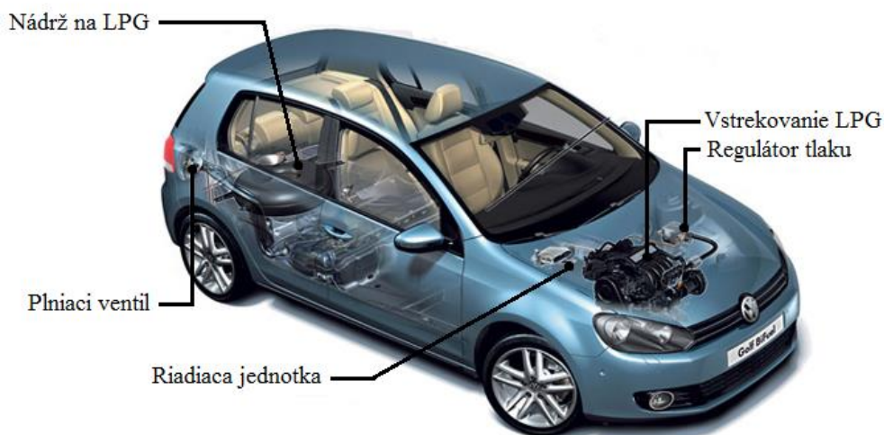
Obr. 1.2 Systém využívajúci LPG palivo vstavaný do benzínového automobilu [35]
