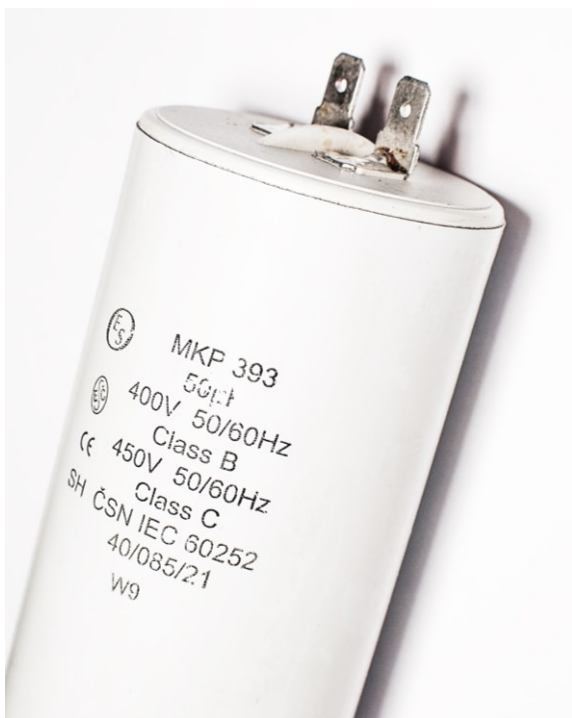
Obrázek 3.15 – Příklad vzhledu kondenzátoru C_p pro pomocné vinutí [5]
