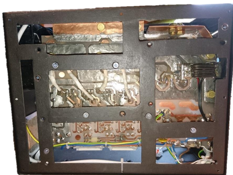
Obr. č. J-4: Pohľad na zadnú časť silových obvodov výkonového meniča so zobrazeným bočným, ktorý sa nachádzal v pravej hornej časti.
