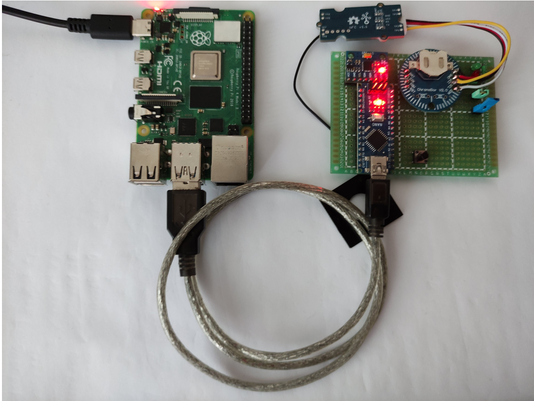
Obr. 4.6: Sériová komunikace mezi Raspberry Pi 4 a modulem.
