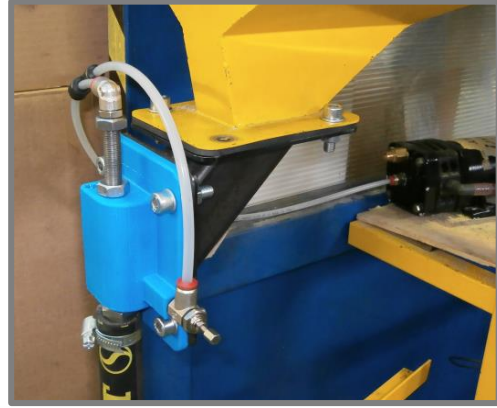
Obr. 4-26 Testování upraveného dávkovače PZ02
