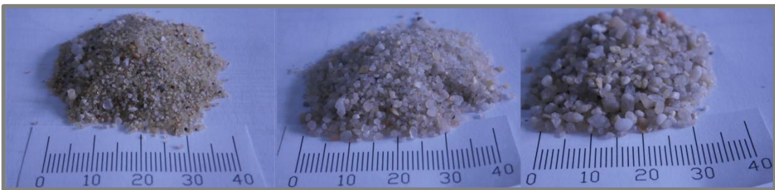
Obr. 4-28 Porovnání zrnitostí písku (vlevo 0,3-0,6 mm; uprostřed 0,6-1,6 mm; vpravo 1,2-4 mm)
