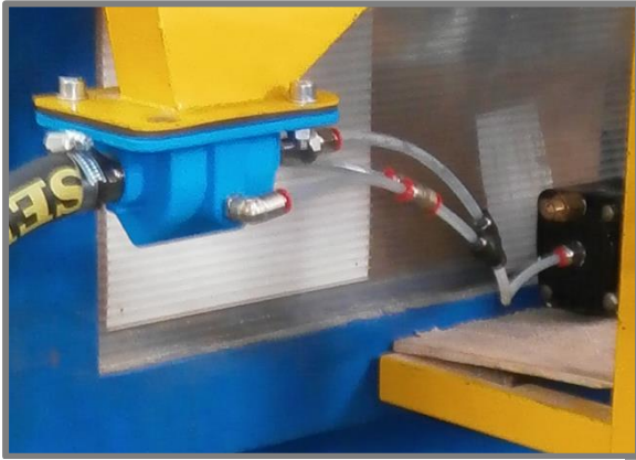
Obr. 4-27 Testování upraveného dávkovače PZ01
