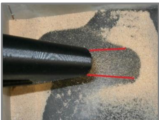
Obr. 4-36 Výsypaný kužel – shora (varianta 1)
