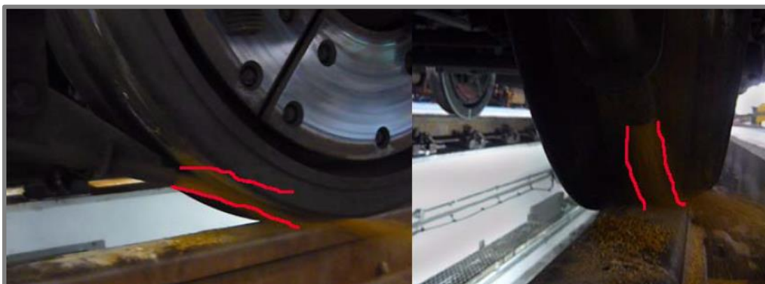
Obr. 1-12 Úzký kužel písku - hadice vybavena výsypanou trubicí [11]
