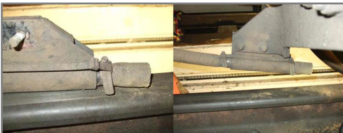
Obr. 1-10 Hadice utažená hadicovými svorkami [11]
