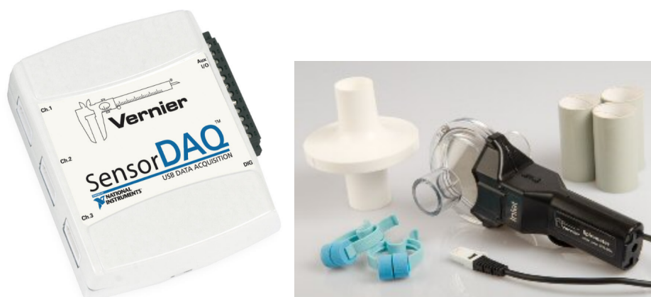
Obr. 4.16: Pomůcky k měření v Labview: a) senzor DAQ, b) spirometr a jeho součásti
