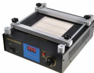
Obrázek 17: Stanice pro přehřev
